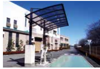
トラックスケール Truck Scale パキューム車の搬入量を計量します。
