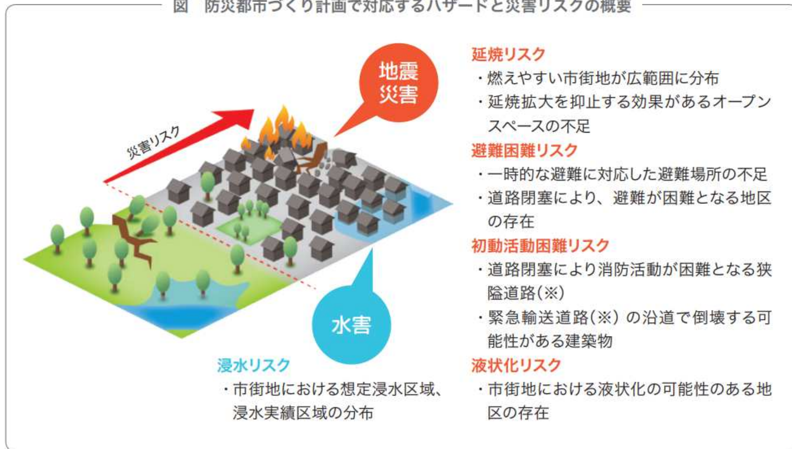
図 防災都市づくり計画で対応するハザードと災害リスクの概要
