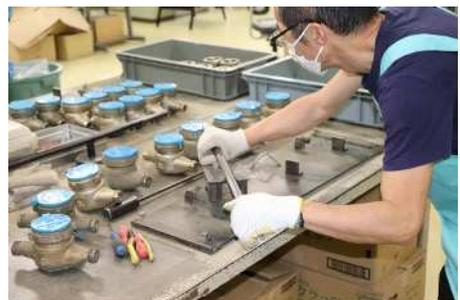
写真 5-5-3 水道メーターの分解作業
