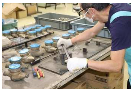
写真 5-5-3 水道メーターの分解作業
