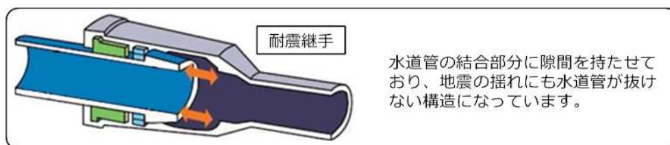
図 2-2-5 耐震性が高い水道管
