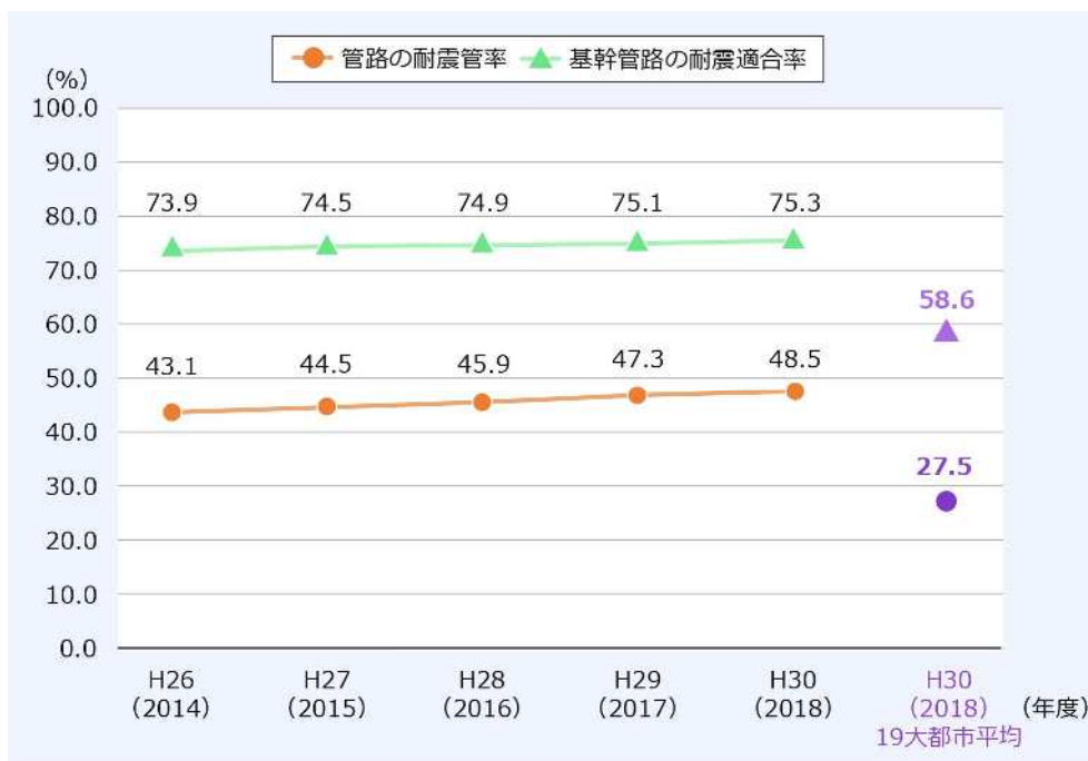
図 3-4-1 管路の耐震管率・基幹管路の耐震適合率の推移(平成 26 年度～平成 30 年度)
