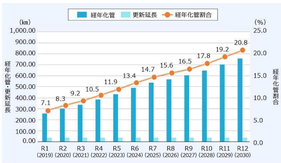
図 3-3-3 法定耐用年数を経過する管路延長及び配水管総延長に占める割合の推計(令和元年度～令和 12 年度)
