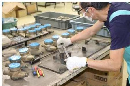
写真 5-5-3 水道メーターの分解作業
