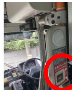
【EDSS 車内非常ブレーキスイッチ】
