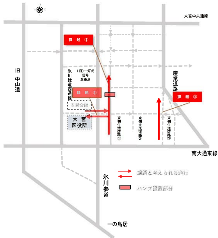
図 交通規制変更に伴う交通量増加による課題となる通行区間
