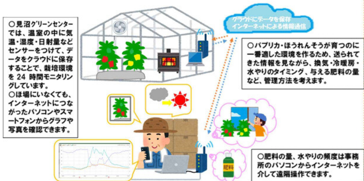
見沼グリーンセンターにおけるスマート農業技術の活用試験の模式図
