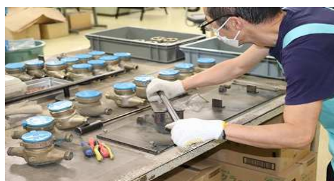
水道メーターの分解作業
