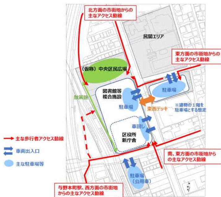
図 9 事業区域の動線計画方針図(施設配置方針を図 8 左とした場合)
