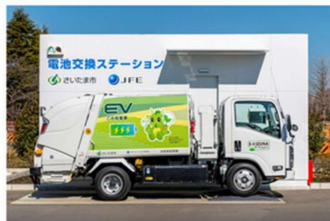
図 22 電池交換ステーション及び電池交換式EVパッカー車
