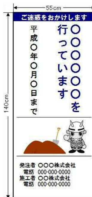
(様式4) 工事説明看板 (占用企業工事)
