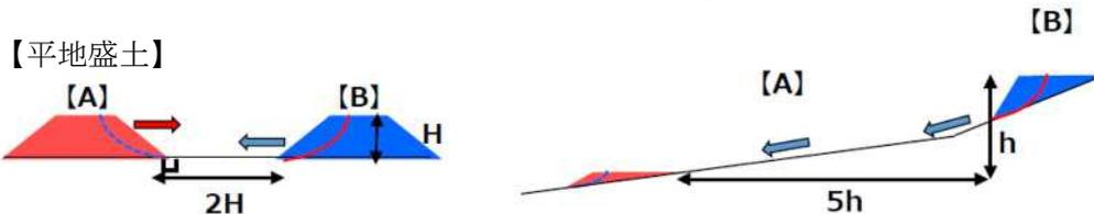
判断基準：盛土間の離隔が  $2H$  以内 判断基準：盛土間の離隔が  $5h$
