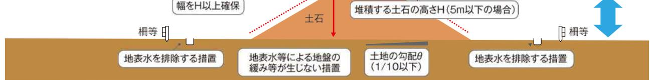
※1 堆積する土石の高さが5m超の場合、当該高さの2倍を超える幅の空地が必要です。
