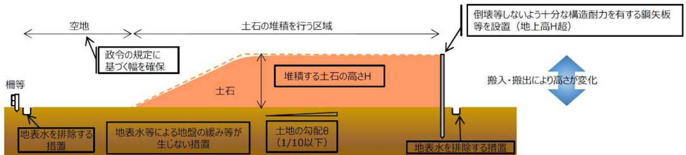
図 鋼矢板等の設置の概念図
