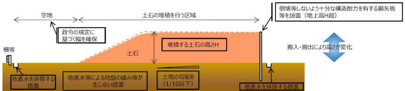
図 鋼矢板等の設置の概念図
