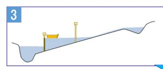
船が一の関を通過すると、一の関には長さ約333cm、幅約18cm、厚さ約6cmの「角落(かくおとし)」と呼ばれる板を1枚ずつ、計10枚ほど積み上げて、水位を高める。
