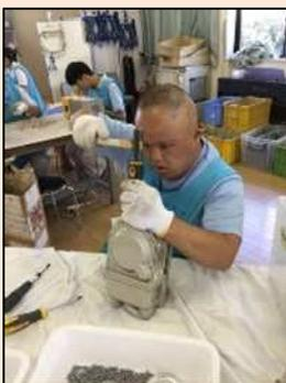
集中してガスメーターの分解作業をしています。
