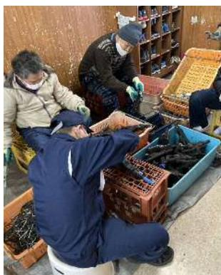
▲電線接続金具の解体再生作業
