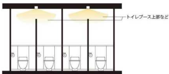
図 07-8 便所内のフラッシュライト(光の点滅で非常時の警報を知らせる装置)
