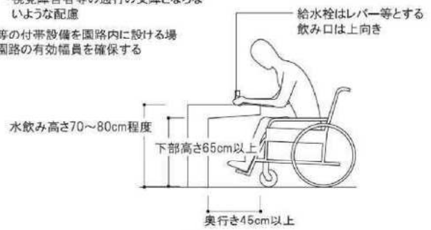
■水飲みの設備
