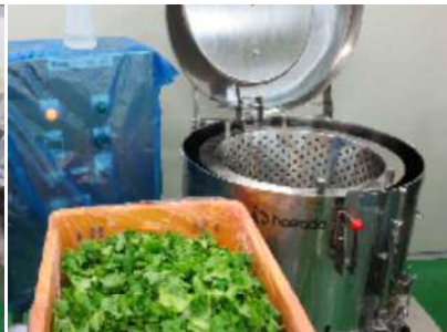
洗浄後の脱水乾燥機のザルの検査: ATP検査で200以下をOPRP
