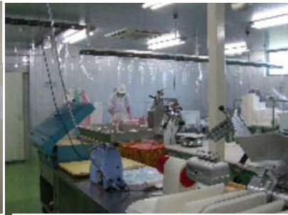
手前: スライスパック清潔ゾーン 奥: 下処理の準清潔ゾーン 左奥: 原材料庫の汚染ゾーン
