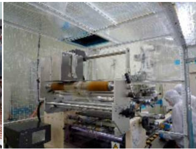
パッケージ工程(クリーンブース) の環境検査をOPRP
