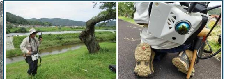
歩行型LiDAR 計測システムのイメージ。
