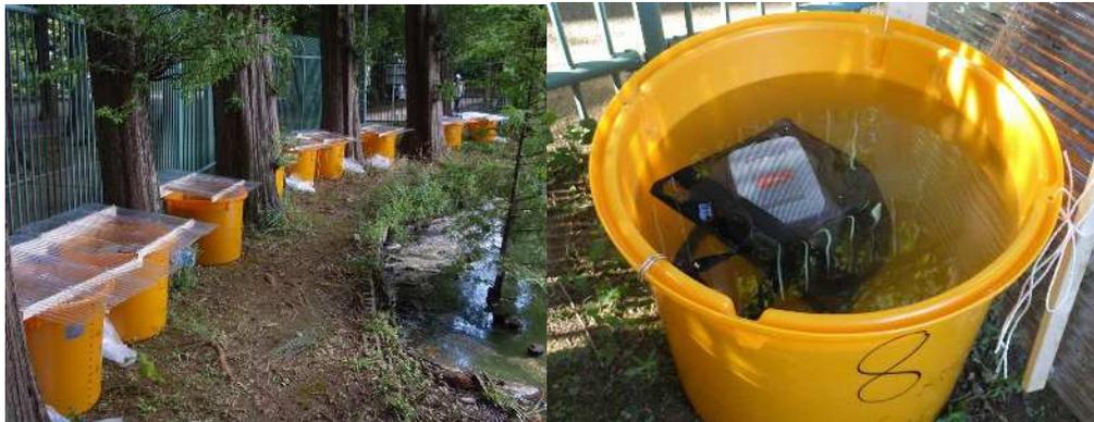
写真1 過酸化水素によるアオコ抑制実験（第一段階実験）
