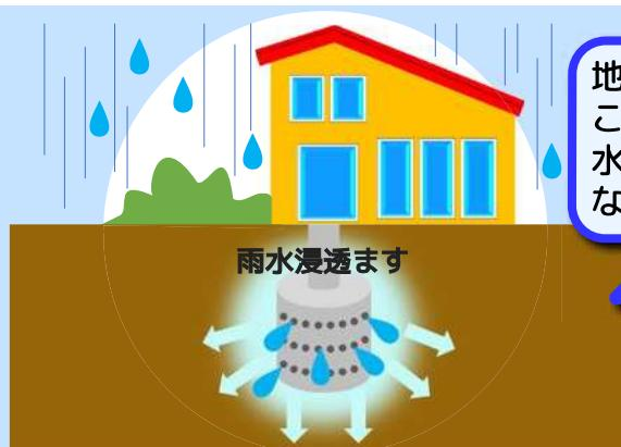
地中に地下水をしみこませることで水害の軽減に加え、地下水涵養による河川の水量確保などの効果が期待されます。
