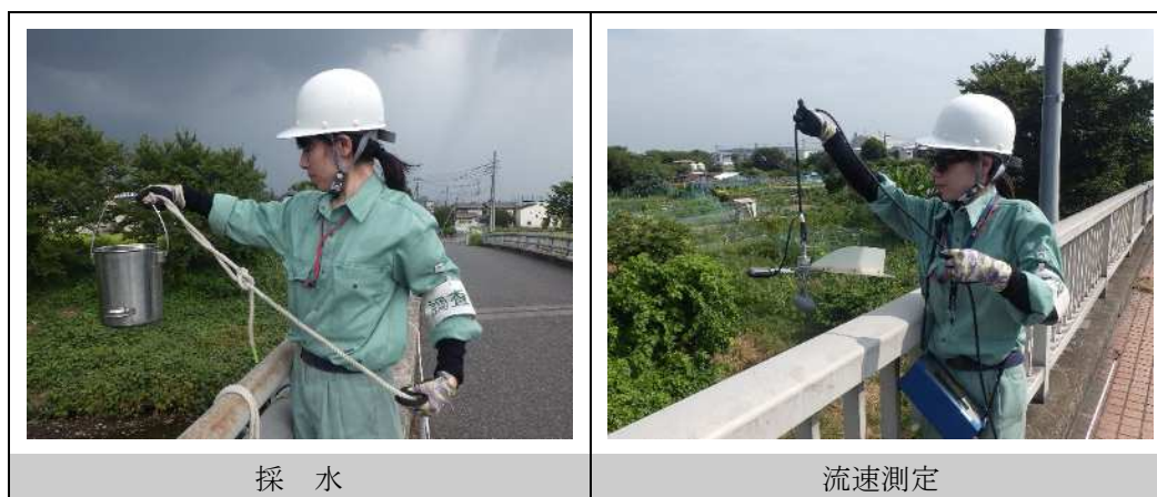
写真 2-3-3 河川環境調査風景
