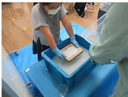
牛乳パックから取り出した紙をミキサーで砕いて 漉き舟に入れ、そこから漉しとります
