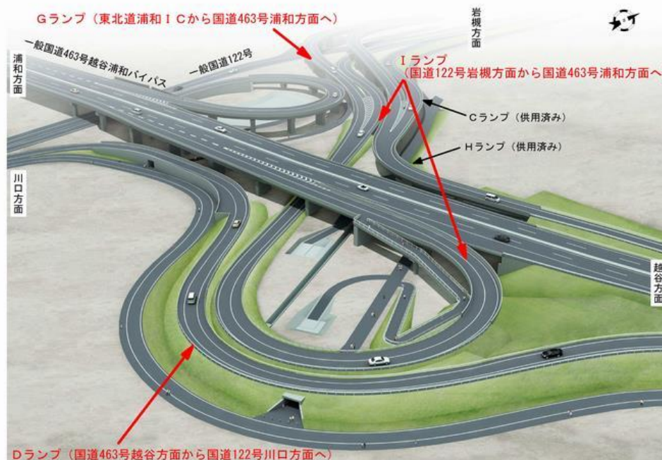
図 2.6-7 一般国道 463 号越谷浦和バイパス（鶴巻ランプ）道路新設改良事業完成イメージ
