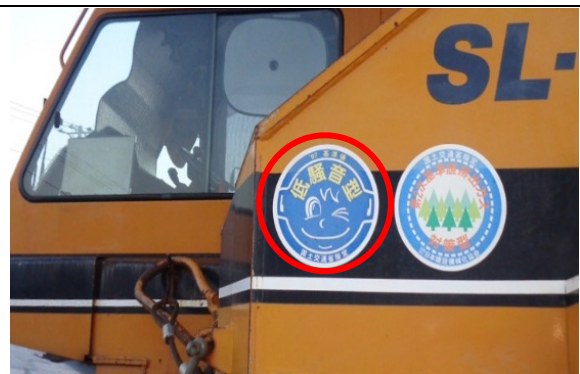
写真 4.2.1(2) 低騒音型建設機械の使用
