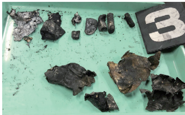
火災現場で発見されたリチウムイオン電池とスプレー缶の燃え殻
