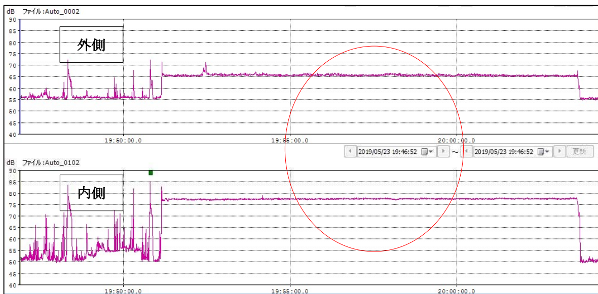
図3.3 鋼板の内側・外側における騒音レベル測定チャート
