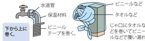
※凍結して水が出ないときは、タオルなどの布をかぶせて、その上からゆっくりぬるま湯をくり返しかけて溶かしてください。急に熱湯をかけると、じゃ口や水道管が破裂することがありますので、特にご注意ください。
