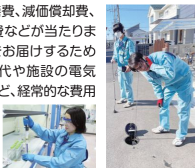
水質検査、漏水調査の様子
